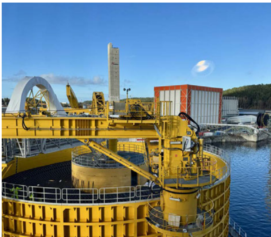
À bord, le bateau Aurora est capable de transporter jusqu'à 10.000 tonnes de câbles. PIERRICK MERLET
